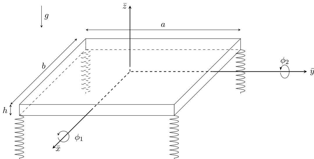
Wir betrachten eine quaderförmige Platte der Länge  $a$ , Breite  $b$ , Dicke  $h$  und Masse  $M$ , die sich im homogenen Schwerfeld der Erde befindet und an den Eckpunkten ihrer Unterseite auf vier identischen Federn mit Federkonstante  $k$  gelagert ist. Die Federn können sich nur vertikal bewegen. Im Gleichgewicht falle der Koordinatenursprung des eingezeichneten Koordinatensystems  $\bar{S}$  mit dem Schwerpunkt zusammen.
