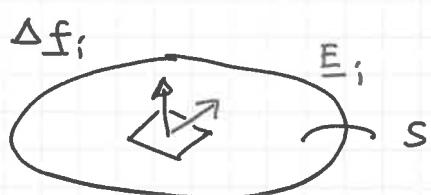
$$\sum_i \underline{E}_i \cdot \underline{\Delta f}_i \rightarrow \int_S d\underline{f} \cdot \underline{E}(\underline{r}) : \text{"Elektrischer Fluss"} \quad (2.56)$$
